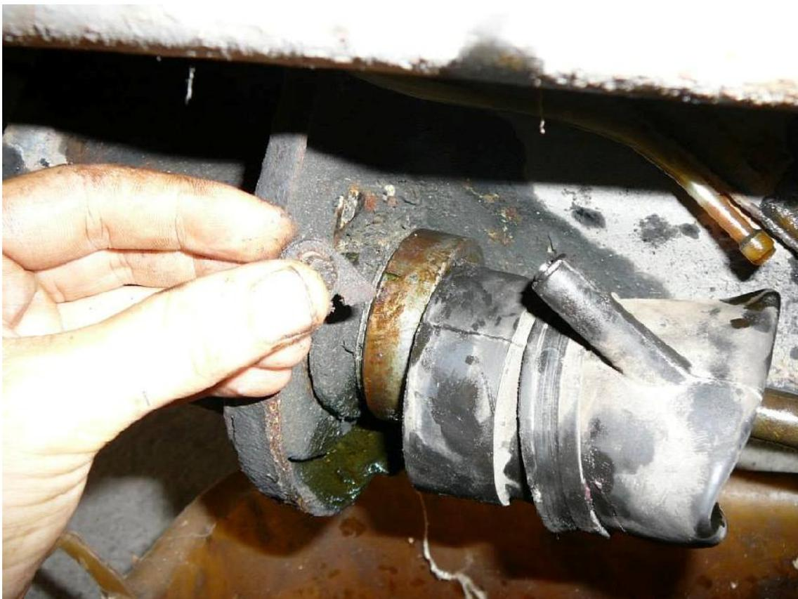
Con la chiave da 8, si svita il bullone che ferma il triangolino che impedisce al cilindro sospensione di ruotare, unico modo per poter essere sfilato
