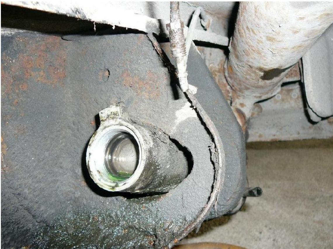
Si vede chiaramente quanta morchia e quanto sporco possano danneggiare il cilindro. Sarà opportuno estrarlo, pulirlo e rimuovere ruggine e morchia dall'alloggiamento prima del montaggio
