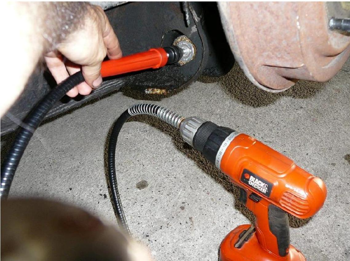
Con santa pazienza, si procede allo smeriglio dei detriti depositati all'interno del supporto. Il minimo granellino di sporco può deteriorare il cilindro entro poche oscillazioni
