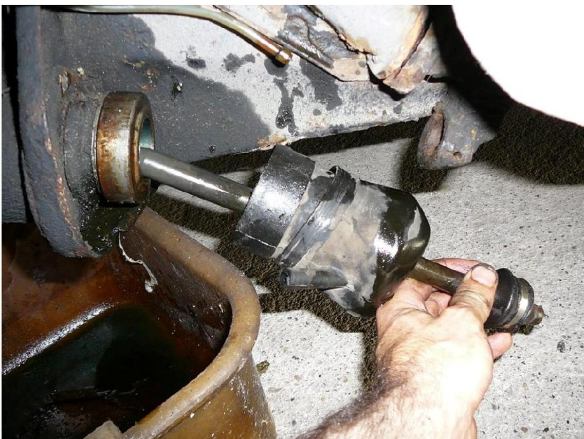
Si fa ruotare il pistone di 90 gradi in senso orario e si procede all'estrazione della sede sfera a dx e
