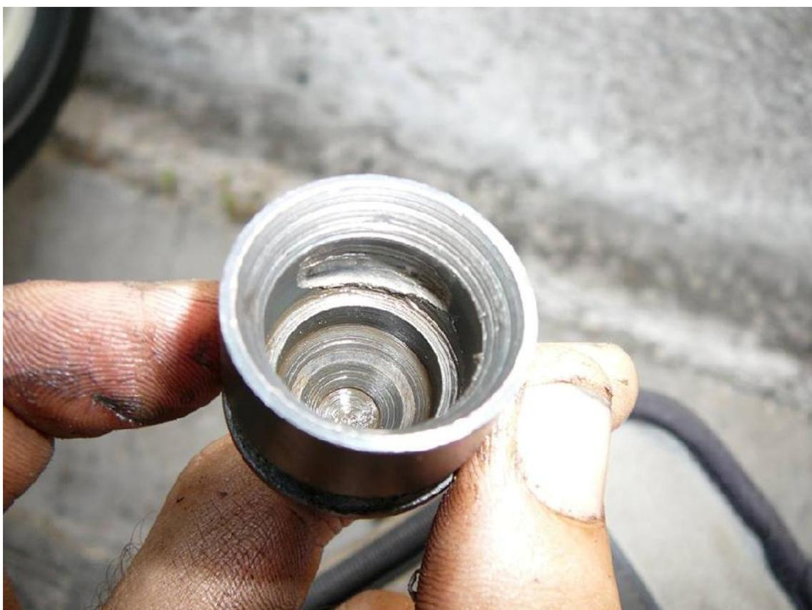
Un esame della vecchia sede della biglia, una volta pulita dal grasso, evidenzia un deterioramento ai lati del corpo interno
