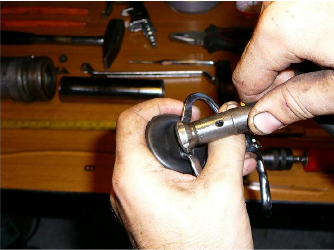
Per facilitare l'operazione, è possibile stringere il corpo della tige in morsa. Non si danneggerà!
