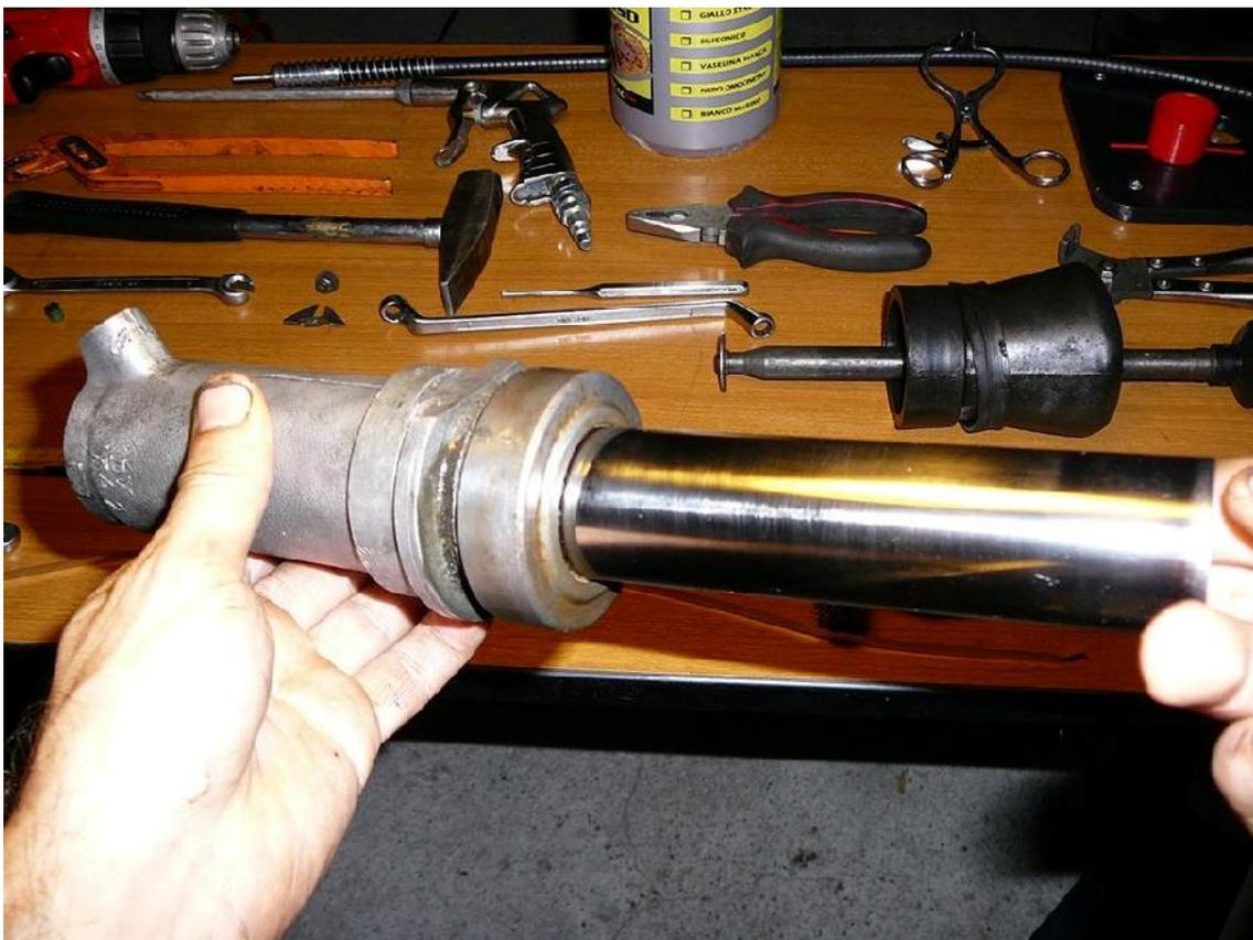
Inseriamo il pistone, dopo averlo ancora passato con un panno morbido che non lascia pelucchi, nel cilindro
