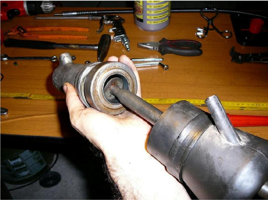
Ora inserire la tige nel pistone cavo appena inserito a propria volta nel cilindro
