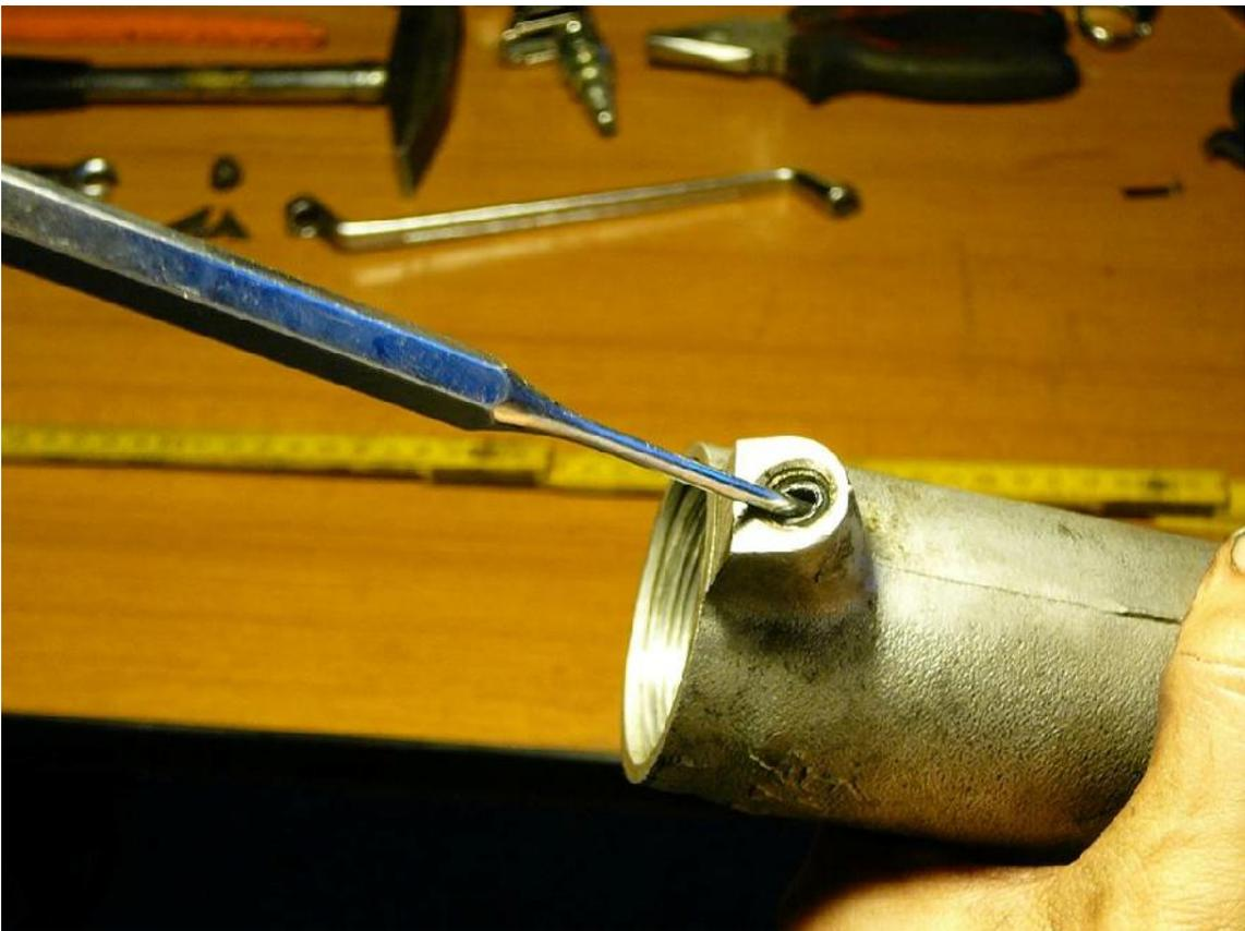
Inserire la guarnizione di tenuta del tubo di alimentazione, possibilmente nuova
