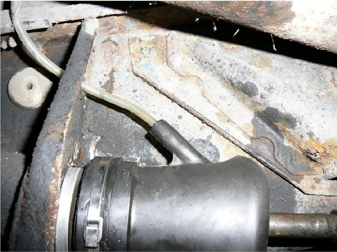
Si innesta il tubo di recupero in rilsan magari con un po' di spray siliconico
