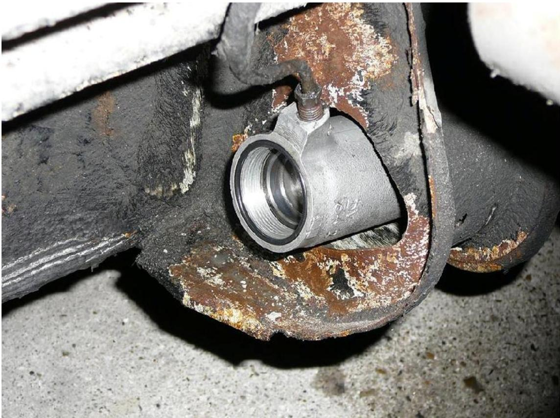
Se il gommino di guarnizione è in stato "dubbio", sostituirlo senza pensiero
